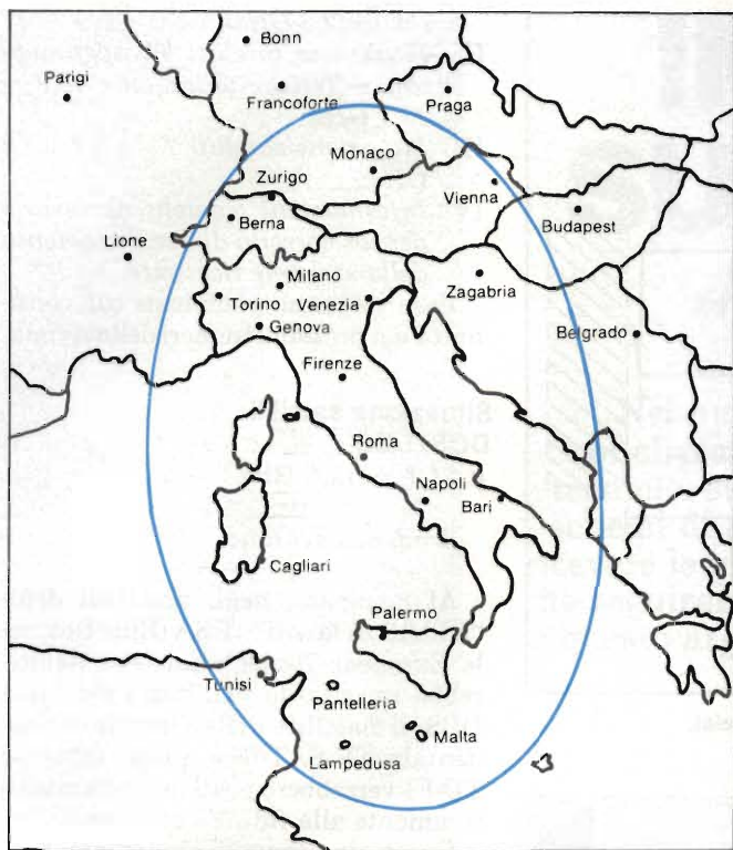
Fig. 2 - Area di copertura del fascio Italia. Il valore di attenuazione ai bordi è di 3 dB. La densità di flusso a terra (PFD) è di -103 dBW/m 2 all'epicentro.
