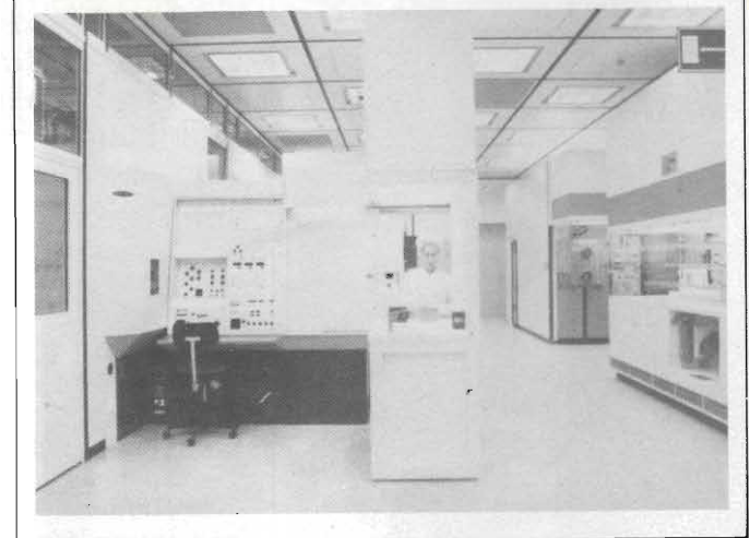
Fig. 5 - Gli ambienti dove vengono preparati i chip non devono contenere pulviscolo atmosferico.
