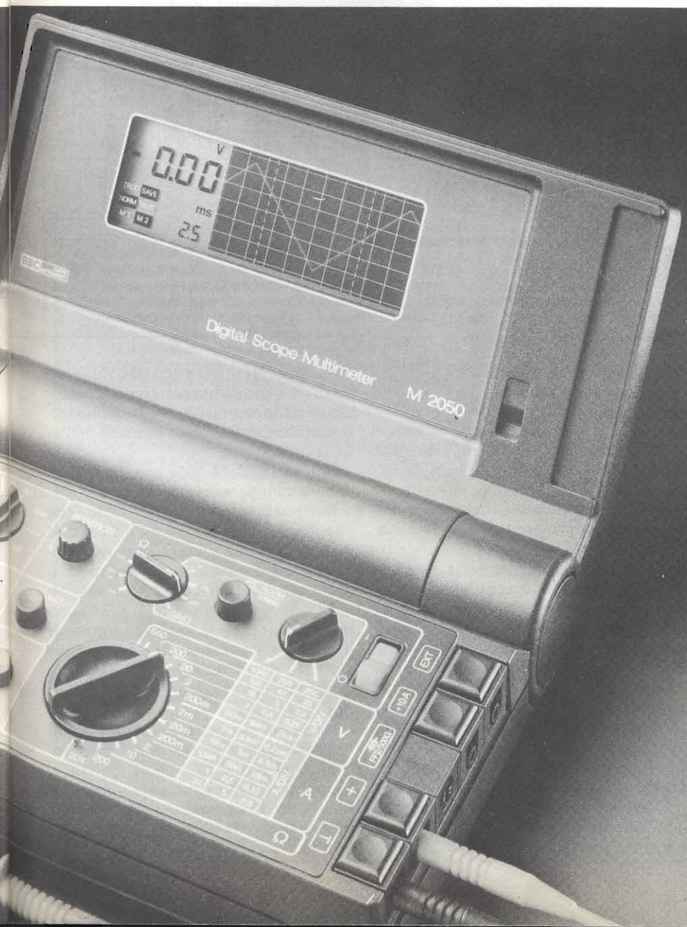
Fig. 2 - Se l'apparecchio di misura risulta isolato, come lo è appunto il Multimetro M 2050, non esistono problemi quando si desidera riprendere oscillograficamente l'andamento della tensione tra collettore ed emettitore (classe di protezione 2).
