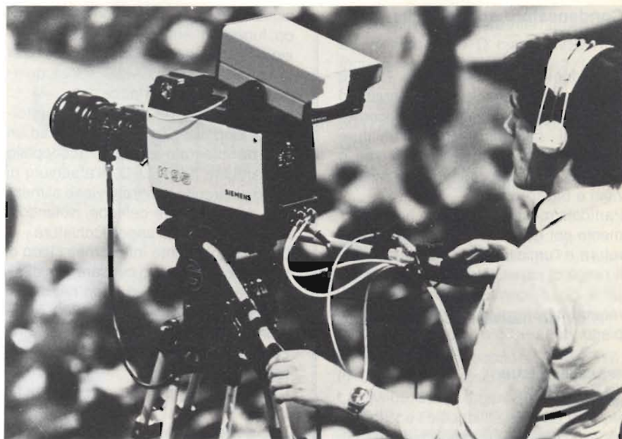
La telecamera a colori K95, realizzata dalla Siemens in esecuzione compatta e con tre cinescopi di ripresa, fornisce immagini brillanti anche in condizioni di luce sfavorevoli.
